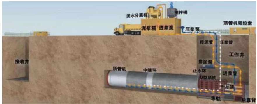
图 2-4 顶管法示意图
