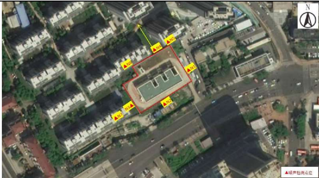
图 4-5 迎水道 110kV 变电站声环境监测布点示意图
