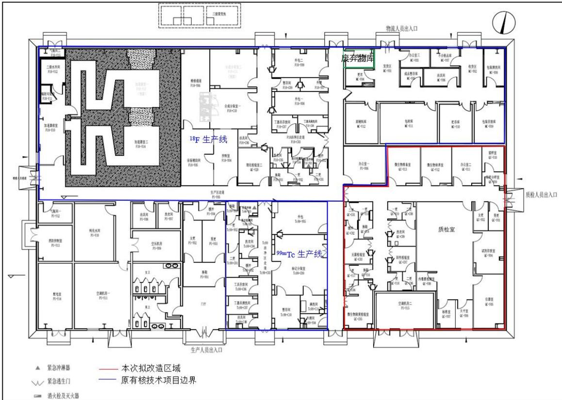
图 10-1 改造前理化检验室一平面布局图
