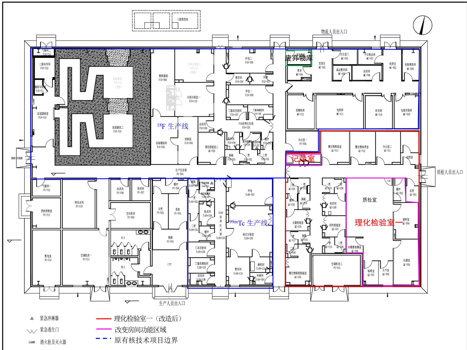
附图 5 生产车间平面布置图（改造后）
